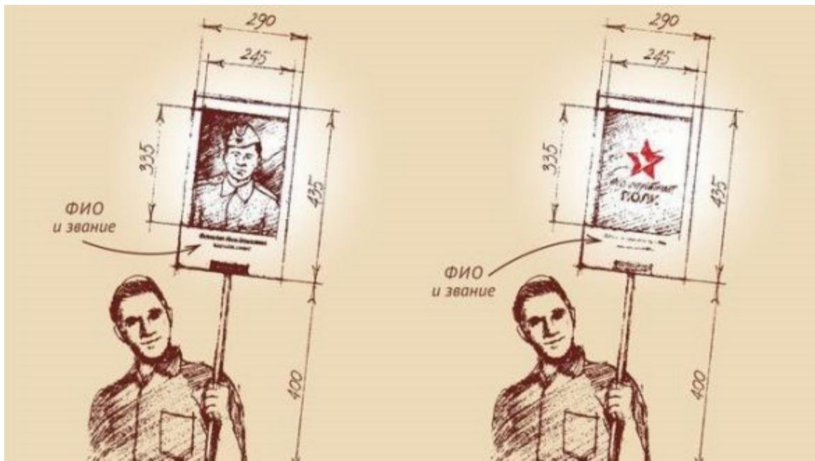
Транспарант делается по единому образцу. Размеры: ширина – 290 мм, длина – 435 мм, длина ручки – 500 мм. Его размеры: 290 x 435 мм. Размер фото: 245 x 335 мм. Транспарант можно изготовить самому из ДВП, фанеры, пластика или любого другого подручного материала любого цвета. Если портрета нет, на плакате можно разместить эмблему акции «Бессмертный полк» ([приложение 2](#)).
